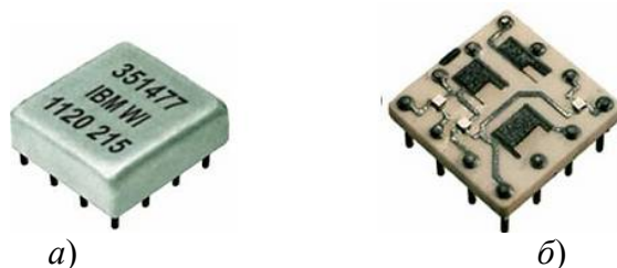
Рис. 1.4. Внешний вид (а) и увеличенное изображение фрагмента платы (б) пленочной микросхемы
