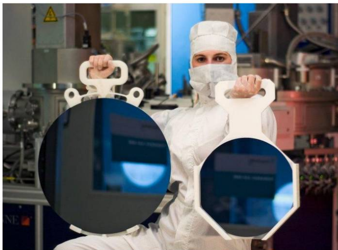
Рис. 4.2. Внешний вид 450 мм и 300 мм полупроводниковых подложек
